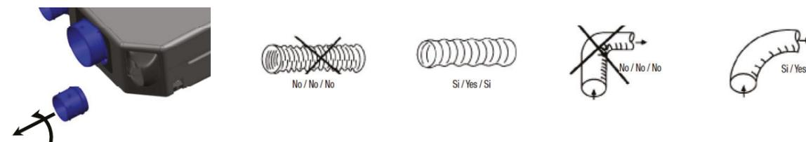
Para mayor facilidad de montaje, desacople la tobera del equipo, fije el conducto a la tobera con la ayuda de las bridas y vuelva a colocar la tobera en el equipo.
