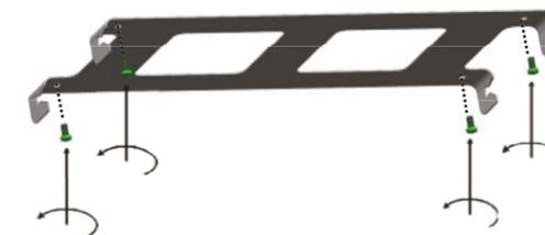
3. Apoye el ventilador en las guías del soporte y apriete los tornillos para asegurar la fijación del equipo al soporte.
