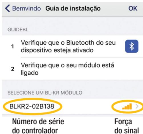
d. Escolha o controlador com o qual deseja conectar-se. Uma indicação de que o seu dispositivo está conectando-se ao controlador aparecerá.
