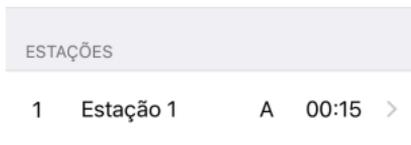
c. Quando for colocado o tempo de operação em alguma estação, pressione **Guardar** e depois **Transmitir** na "home screen":
